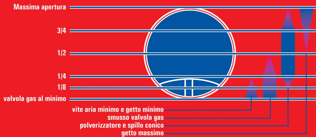
La figura di cui sopra, rappresenta schematicamente il diffusore, ed indica l'influenza dei vari particolari relativamente all'apertura della valvola gas; è puramente indicativo ed è comunque funzione della combinazione dei vari componenti e delle caratteristiche geometriche dello spillo conico.
